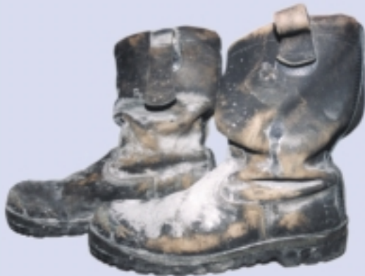
Bild 9: Brandeinwirkung auf Feuerwehrsicherheitsschuhwerk.
