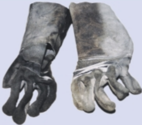
Bild 8: Beim Einsatz zerstörte Schutzhandschuhe aus Leder.
