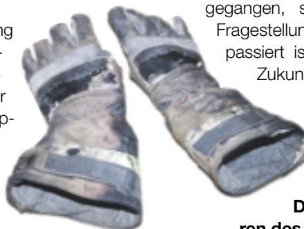
Bild 3: Vom Einsatz gezeichnete Feuerwehrschtzhandschuhe nach DIN EN 659.
