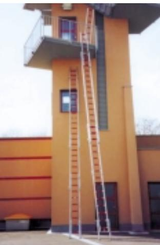
In der Variante „zwei Anlegeleitern miteinander verbunden und mit einem Aufsteckteil“ verfügt die MFL über eine Gesamtlänge von 9,20 m.
