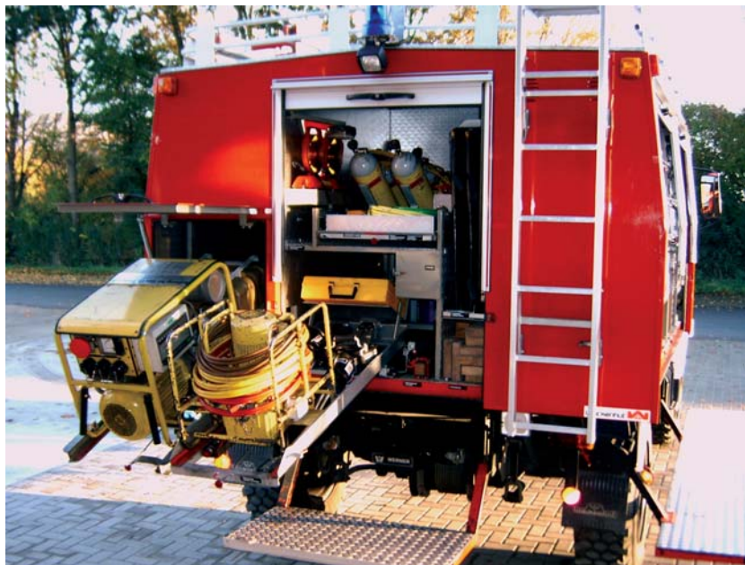
Schweres Gerät auf Schlitzen: Stromerzeuger und Pumpenaggregat
