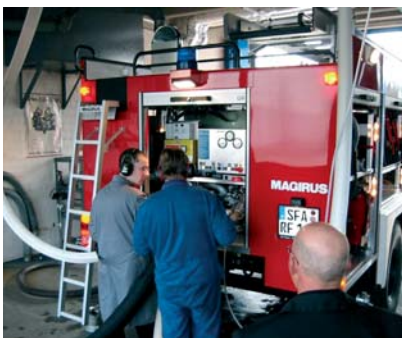
Pumpenprüfung während der Fahrzeugabnahme
