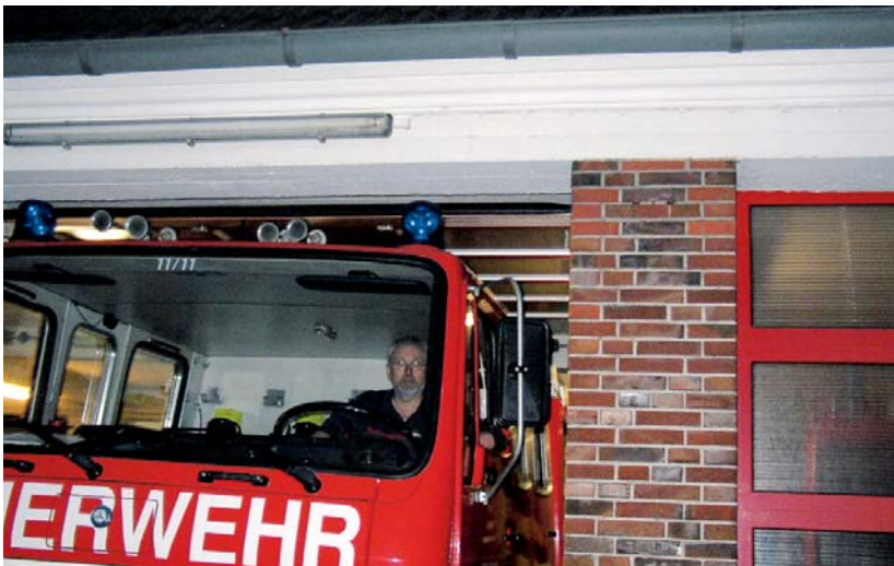
Mit angeklapptem Außenspiegel: Zu enge Torausfahrt
